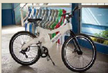
Bicicleta da marca Muzzicycle é fabricada por injeção
